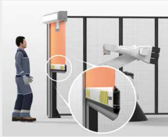
Versión A Lado plano del perfil orientado hacia la cara frontal de la puerta
